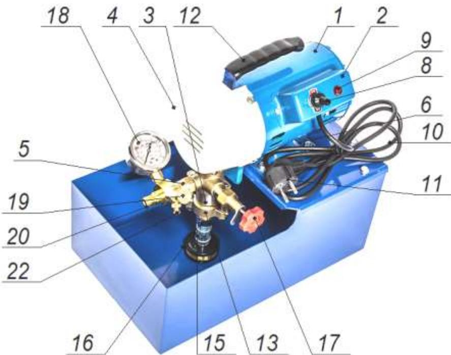
4.5. Система для подачи воды под высоким давлением включает в себя нагнетательный клапан с вентилем 17 для регулировки давления, манометр 18, вентиль 19 для слива воды и два штуцера:
